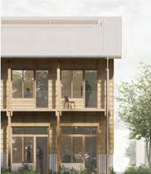
Fig.21. Inden for byggefelt 1-4 skal bebyggelsen fremtræde med base i profileret beton og med øvrige facader og synlige konstruktioner i træ på klink. Tage skal fremstå med profilerede metalplader © Loop Architects & Kragh Berglund
