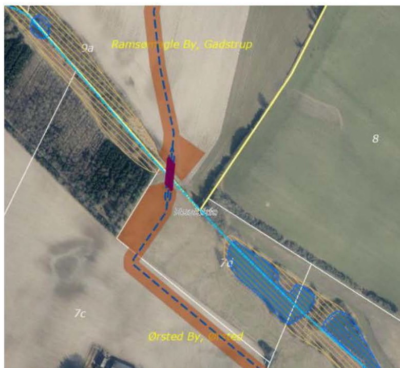
Figur 3: Figur 3.2. Vandløb på matr.nr. 9a, Ramsømagle By, Gadstrup og 7d, Ørsted By, Ørsted. Der foretages styret underboring, vist med lilla. Kabeltracé er vist med blå stiplede linje og arbejdsbæltet er vist med brun. Lyseblå streg-prik-linje er § 3 vandløb.
