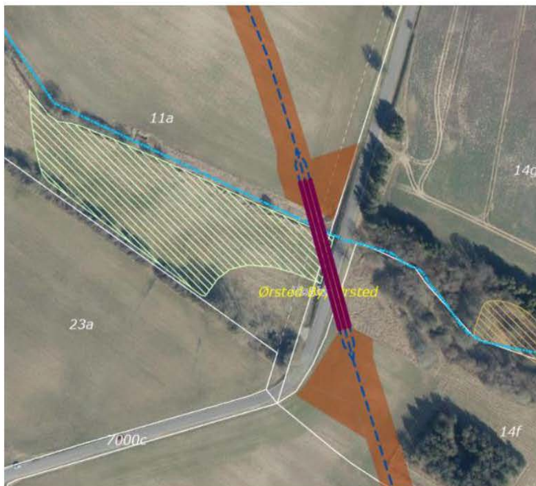
Figur 4: Vandløb på matr.nr. 11a Ørsted By, Ørsted. Der foretages styret underboring, vist med lilla. Kabeltracé er vist med blå stiplede linje og arbejdsbæltet er vist med brun. Lyseblå streg-prik-linje er § 3 vandløb.
