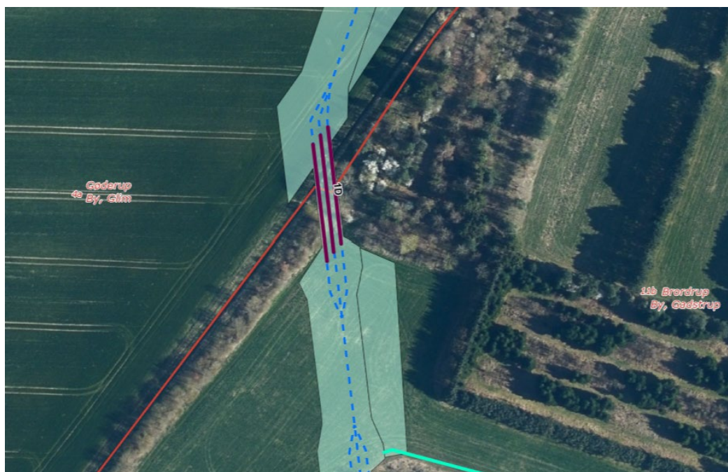
Figur 2: Vandløb mellem matr.nr. 4a, Gøderup By, Glim; og 11b, Brødrup By, Gadstrup. Der foretages styret underboring, vist med lilla. Kabeltracé er vist med blå stiplede linje og arbejdsbæltet er vist med grøn. Rød linje viser vandløbet og samtidig kommunegrænsen Lejre/Roskilde Kommune.
